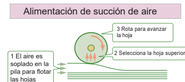
Sección de alimentación de succión en un contenedor Capacidad de alimentación estable para una amplia gama de hojas.
